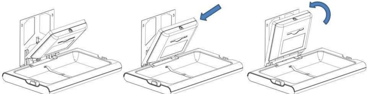
Abrir el dispensador de sábanas con la llave especial suministrada. Los cuatro orificios de fijación de este dispensador de sábanas a la estructura de sujeción del cambiapañales quedarán a la vista.
